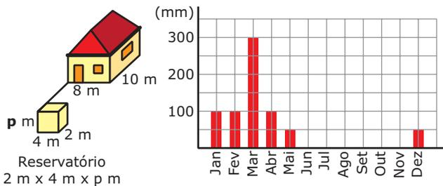
Sabendo que 100 milímetros de chuva equivalem ao acúmulo de 100 litros de água em uma superfície plana horizontal de um metro quadrado, a profundidade **p** do reservatório deverá medir
