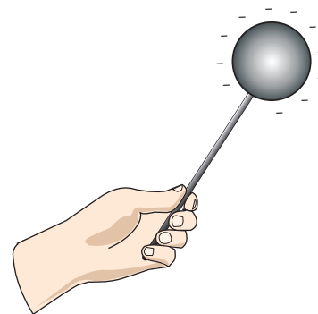
Figura 1: A carga elétrica de um condutor se distribui sobre a sua superfície externa.
