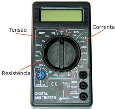
Figura 7: Um multímetro para medição da corrente, da tensão elétrica (contínua e alternada) e da resistência.
