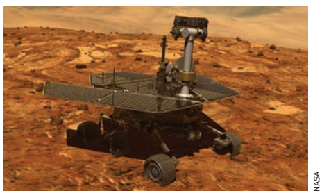
Figura 1: O robô Spirit, da NASA, é movido por uma fonte de f.e.m. que converte energia solar em energia elétrica.
