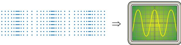
Veja que as compressões e rarefações da onda sonora são representadas no osciloscópio por cristas e por vales, respectivamente. Dessa forma, fazendo a leitura do aparelho, podemos determinar as grandezas características da onda sonora (período, frequência, velocidade, comprimento de onda e amplitude). Ou seja, o osciloscópio nos permite "visualizar" a onda sonora. Nas figuras a seguir, representaremos, exceto quando especificado o contrário, a onda sonora conforme vista na tela do osciloscópio.
