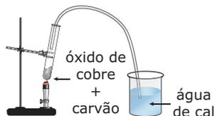
Uma mangueira que penetra no interior do tubo de ensaio tem sua outra extremidade mergulhada em uma solução de água de cal, contida num béquer.
