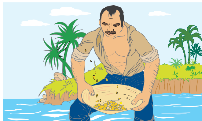
A bateia é uma gamela (vasilha de madeira ou de barro com a forma de escudela grande) que se usa na lavagem das areias auríferas ou do cascalho diamantífero.
