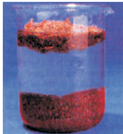
Separação da serragem misturada com areia por flotação. A serragem flutua enquanto a areia sedimenta.
