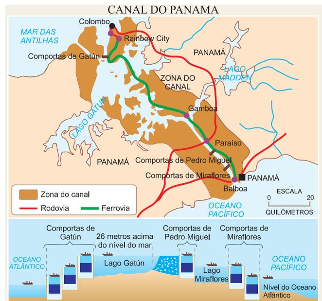
O Canal do Panamá é um sistema de barragens e comportas que permite aos navios ganhar as alturas do istmo. A rigor, não é um canal, pois as águas do Pacífico e do Atlântico não se comunicam.
