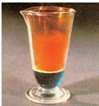
A reação de cobre com \text{HNO}_3 produz nitrato de cobre (a solução é azul) e liberação de \text{NO}_2 (gás marrom).
