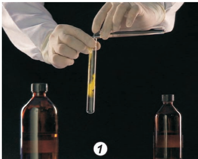
Na foto 1, uma solução incolor de KI é adicionada a uma solução incolor de \text{Pb}(\text{NO}_3)_2 . Na foto 2, forma-se um precipitado amarelo de \text{PbI}_2 .
