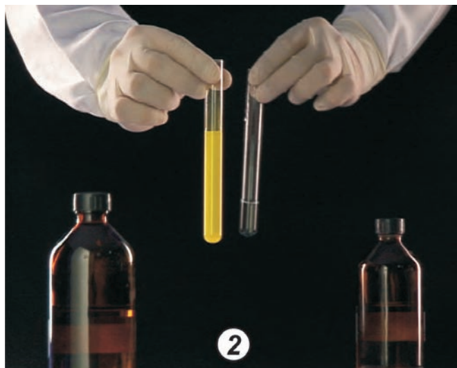
Na foto 1, uma solução incolor de KI é adicionada a uma solução incolor de \text{Pb}(\text{NO}_3)_2 . Na foto 2, forma-se um precipitado amarelo de \text{PbI}_2 .
