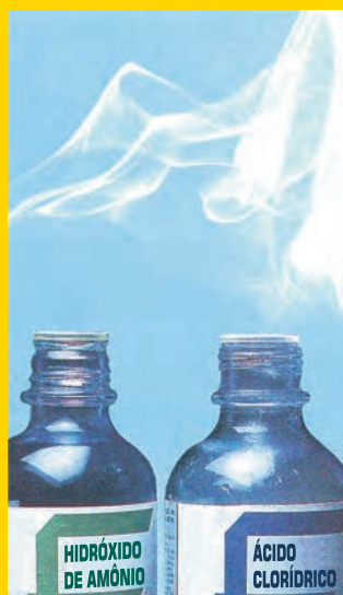
Abrindo os dois frascos, os gases reagem formando cloreto de amônio sólido (névoa branca)
