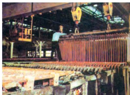
Preparação dos eletrodos de cobre para a purificação eletrolítica.
