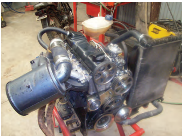
Motor a explosão, originalmente a gasolina, convertido para o uso de biodiesel.
