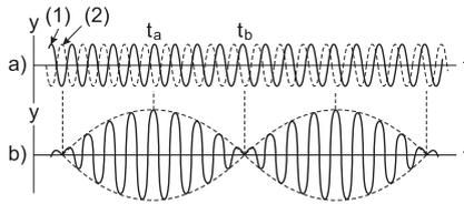
figura a): superposição das ondas (1) e (2).
