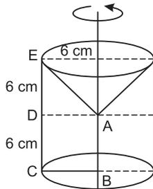
O volume do sólido gerado é o volume de um cilindro circular reto de raio da base 6 cm e altura 12 cm menos o volume de um cone circular reto de raio da base 6 cm e altura 6 cm.
