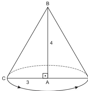
I) O sólido gerado é um cone de raio da base 3 cm e altura 4 cm.
