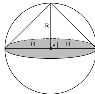
$$\frac{V_{\text{esf.}}}{V_{\text{cone}}} = \frac{\frac{4}{3} \cdot \pi \cdot R^3}{\frac{1}{3} \cdot \pi \cdot R^2 \cdot R} = 4 \Rightarrow V_{\text{esf.}} = 4 \cdot V_{\text{cone}}$$
