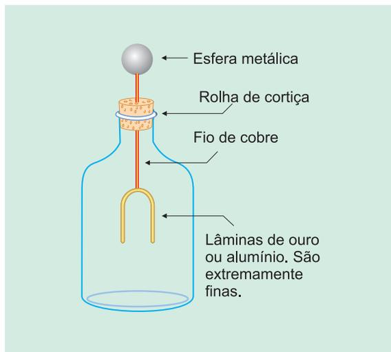
Fig. 5a – Eletroscópio de folhas, longe de cargas elétricas.
