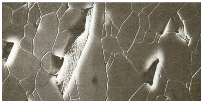
A foto mostra a superfície de um pedaço de alumínio, na qual se podem observar grãozinhos (cristais) empacotados firmemente.
