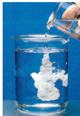
Precipitação de AgCl observada no momento em que uma solução aquosa de AgNO_3 é adicionada a uma solução aquosa de NaCl .
