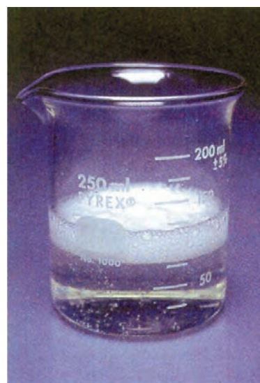
Efervescência observada após se adicionar uma solução aquosa de \text{HCl} a outra de \text{Na}_2\text{CO}_3 .
