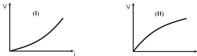
Figura 4. Gráficos de resistores não lineares: I) gráfico do filamento de uma lâmpada; II) gráfico de um VDR (voltage dependent resistor)
