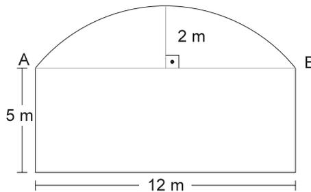
Para a construção da cobertura, o mestre de obras precisa saber a cada metro da viga AB a que altura está a cobertura. Assim, precisamos calcular com exatidão as alturas  $y_1, y_2, y_3$  etc. que aparecem na seguinte figura:
