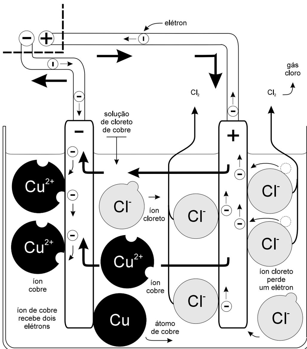
Quando se mergulha na solução de cloreto de cobre dois fios ligados numa pilha, observa-se que:
