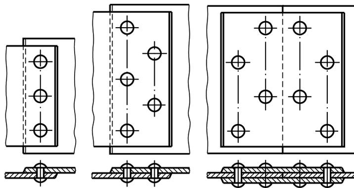
Quanto à distribuição dos rebites, existem vários fatores a considerar: o comprimento da chapa, a distância entre a borda e o rebite mais próximo, o diâmetro do rebite e o **passo**.
