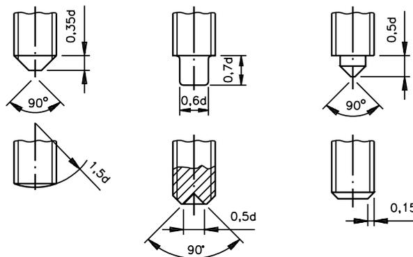
As medidas dos parafusos com sextavado interno com e sem cabeça e o alojamento da cabeça, são especificadas na tabela, a seguir. Essa medidas variam de acordo com o diâmetro ( $d$ ).
