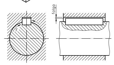
As chavetas paralelas não possuem cabeça. Quanto à forma de seus extremos, eles podem ser retos ou arredondados. Podem, ainda, ter parafusos para fixarem a chaveta ao eixo.
