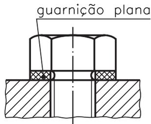
Abaixo está a ilustração de guarnição para junção fixa, denominada arruela Dowty, formada por dois anéis. O **externo** é de metal e o **interno** é de material elástico.
