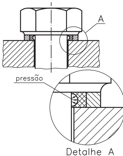
A ampliação mostra como a **pressão** deforma o anel elástico, aumentando a vedação. É utilizada para fluidos gasosos.
