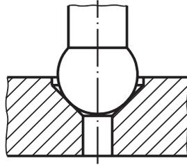
**Vedação em faca**, para médias pressões – efetuada mediante a aproximação de uma coroa circular a um plano.
