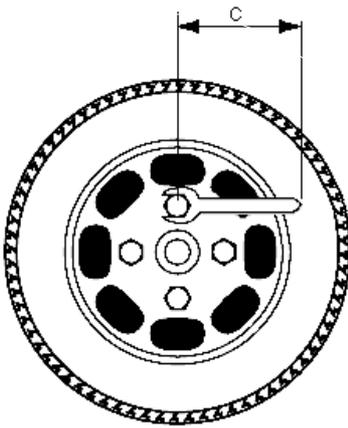
Um artifício simples ajuda a reduzir bastante a dificuldade de realizar esta tarefa: basta encaixar um cano na haste da chave, de modo a alongar o comprimento do braço.
