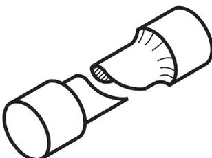
Para materiais frágeis, a fratura se dá segundo uma superfície não plana, mas que corta o eixo longitudinal segundo uma linha que, projetada num plano paralelo ao eixo, forma  $45^\circ$  aproximadamente com o mesmo (fratura helicoidal).
