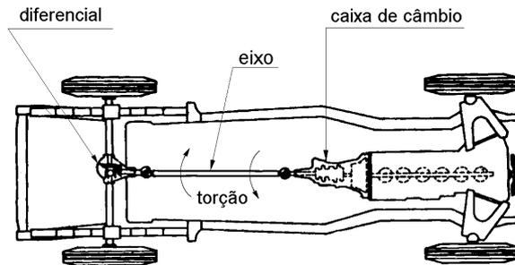
O motor transmite uma força de rotação a uma extremidade do eixo. Na outra extremidade, as rodas oferecem resistência ao movimento.
