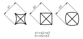
Como o cálculo do valor de dureza Vickers utiliza a medida da média de duas diagonais, esses erros afetam o resultado da dureza: teremos um valor de dureza maior do que o real nos casos de afundamento e um valor de dureza menor do que o real, nos casos de aderência.
