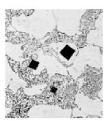
Na microdureza, como a carga aplicada é pequena, a impressão produzida é microscópica, como mostra a figura ampliada, ao lado.
