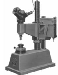
A microdureza Vickers envolve o mesmo procedimento prático que o ensaio Vickers, só que utiliza cargas menores que 1 kgf. A carga pode ter valores tão pequenos como 10 gf.
