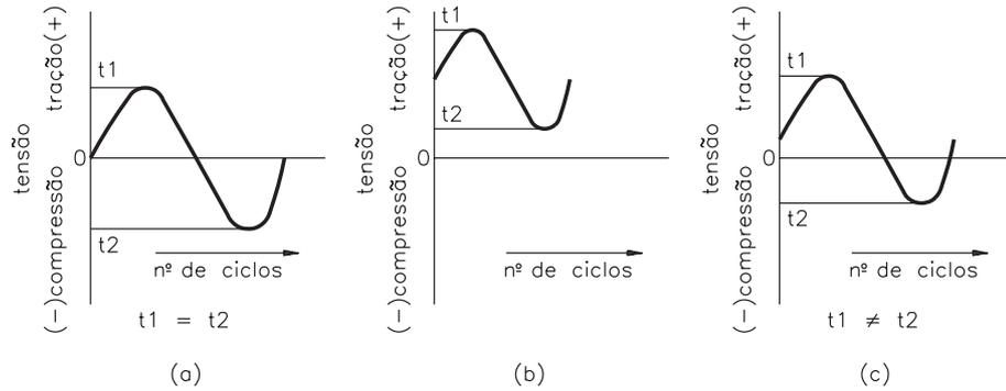
A figura **a** mostra um gráfico de tensão reversa, assim chamado porque as tensões de tração têm valor igual às tensões de compressão.
