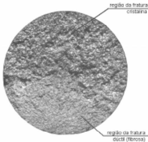
Você pode observar aproximadamente o que acontece na fadiga, dobrando repetidamente um pedaço de arame de aço. Após dobrar algumas vezes, se você observar atentamente, notará algumas pequenas trincas. Se continuar dobrando, observará que a trinca aumenta de tamanho até ocorrer a ruptura do arame.
