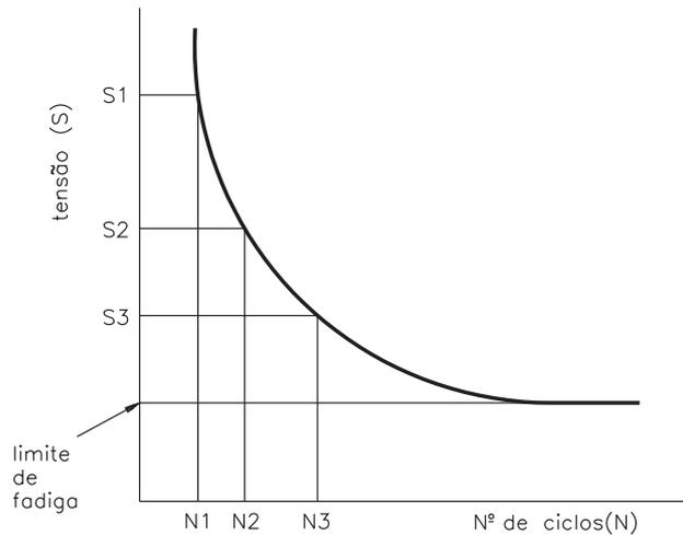
Mas, para a maioria dos materiais, especialmente os metais não ferrosos como o alumínio, a curva obtida no diagrama S-N é decrescente. Portanto, é necessário definir um número de ciclos para obter a correspondente tensão, que será chamada de resistência à fadiga.
