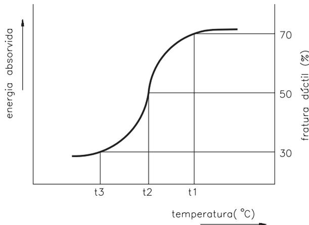
A temperatura T1 corresponde à fratura 70% dúctil e 30% frágil. A temperatura T3 corresponde à fratura 30% dúctil e 70% frágil. E a temperatura T2 é o ponto no qual a fratura se apresenta 50% dúctil e 50% frágil. O intervalo de temperatura de transição corresponde ao intervalo entre T1 e T3.
