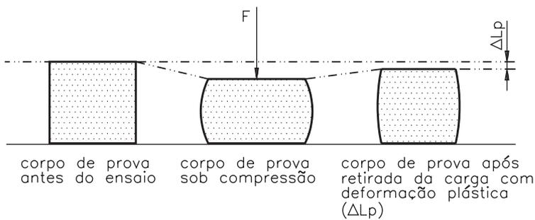
Nos ensaios de compressão, a lei de Hooke também vale para a fase elástica da deformação, e é possível determinar o módulo de elasticidade para diferentes materiais.
