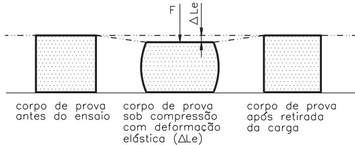
Na fase de deformação plástica, o corpo retém uma deformação residual depois de ser descarregado.
