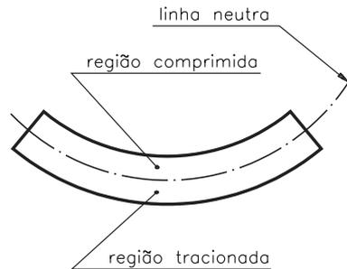
Quando esta força provoca somente uma deformação elástica no material, dizemos que se trata de um esforço de **flexão**. Quando produz uma deformação plástica, temos um esforço de **dobramento**.
