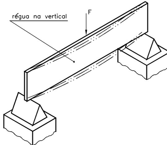
E então? O que aconteceu? No primeiro caso, ocorreu uma grande flexão. No segundo, a flexão foi quase nula. Isso tudo só porque você mudou a forma da superfície sobre a qual estava aplicando a força. Para cada formato existirá um **momento de inércia** diferente.
