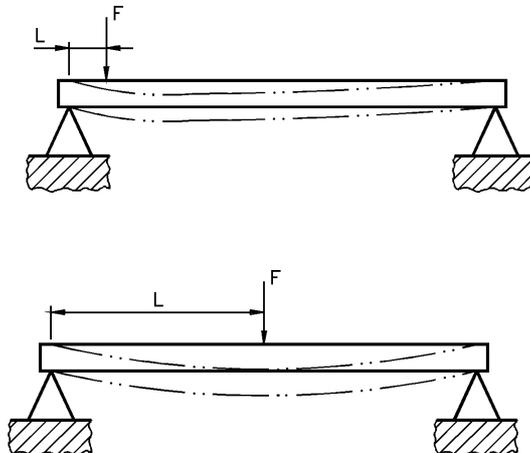
Logo, verificamos que a flexão da barra não depende só da força, mas também da distância entre o ponto onde a força é aplicada e o ponto de apoio.
