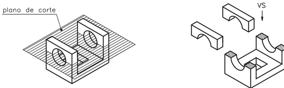
Este plano de corte, que é paralelo ao plano de projeção horizontal, é chamado **plano longitudinal horizontal**. Ele divide a peça em duas partes. Com o corte, os furos redondos, que antes estavam ocultos, ficaram visíveis.
