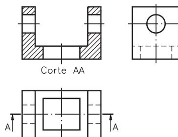
A vista superior e a vista lateral esquerda **não** devem ser representadas em corte porque o observador não as imaginou atingidas pelo plano de corte. A vista frontal está representada em corte porque o observador imaginou o corte vendo o modelo de frente.
