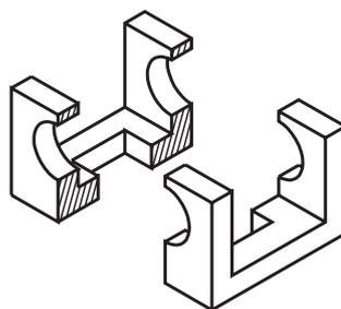
Imagine que a parte anterior do modelo foi removida. Assim, você poderá analisar com maior facilidade os elementos atingidos pelo corte. Acompanhe a projeção do modelo secionado no plano de projeção vertical.
