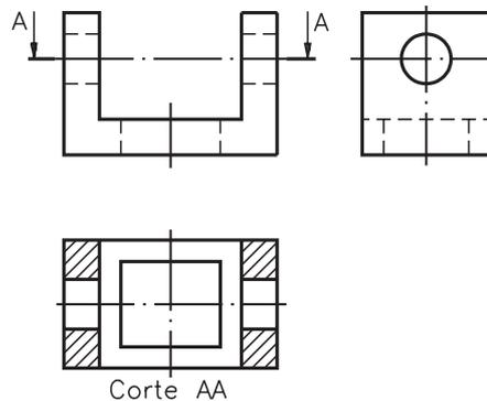
O corte aparece representado na vista superior. As partes maciças atingidas pelo corte foram hachuradas.
