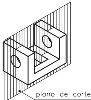
O plano de corte paralelo ao plano de projeção vertical é chamado **plano longitudinal vertical**. Este plano de corte divide o modelo ao meio, em toda sua extensão, atingindo todos os elementos da peça.
