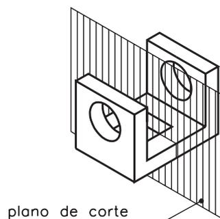
Observe na figura seguinte, que a parte anterior ao plano de corte foi retirada, deixando visível o furo quadrado.
