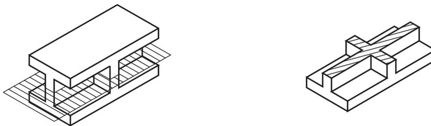
Tanto a nervura longitudinal como a nervura transversal foram atingidas pelo corte no sentido transversal. Então, não há necessidade de representar as nervuras com omissão de corte. No desenho técnico, as duas nervuras devem ser hachuradas. Tente você!
