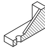
Como você vê, as áreas atingidas pelo corte são semelhantes. Para diferenciar as vistas ortográficas das duas peças, de modo a mostrar qual das duas tem estrutura mais leve, a peça com nervura deve ser representada com omissão de corte. Veja.
