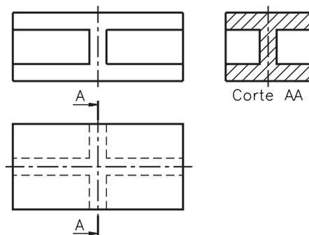
Analisar uma outra possibilidade. Imagine a mesma peça cortada por um plano de corte longitudinal horizontal.
