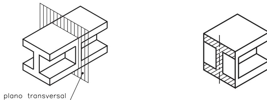
Neste caso, a vista atingida pelo corte é a lateral. A nervura longitudinal deve ser representada hachurada, por que foi atingida pelo corte transversal. A nervura transversal deve ser representada com omissão de corte. Observe, com atenção, as vistas ortográficas da peça, cortada pelo plano transversal.
