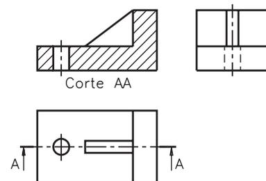
Note que, embora a nervura seja uma parte maciça, ela foi representada no desenho técnico **sem hachuras**. Na vista em corte, as hachuras da nervura foram omitidas.
