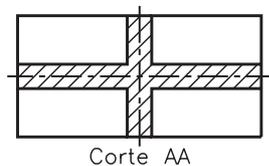
Isso porque as duas nervuras da peça foram atingidas transversalmente pelo corte.
