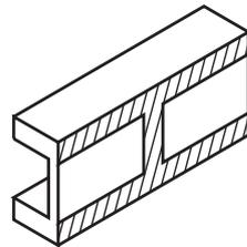
Nas vistas ortográficas desta peça, a vista representada em corte é a vista frontal. Na vista frontal, a nervura atingida longitudinalmente pelo corte é representada com omissão de corte. A nervura transversal é representada hachurada.
