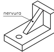
A escora da esquerda é inteiramente sólida, maciça. Já a escora da direita, com nervura, tem uma estrutura mais leve, com menos quantidade de partes maciças. Imagine as duas peças seccionadas no sentido longitudinal.
