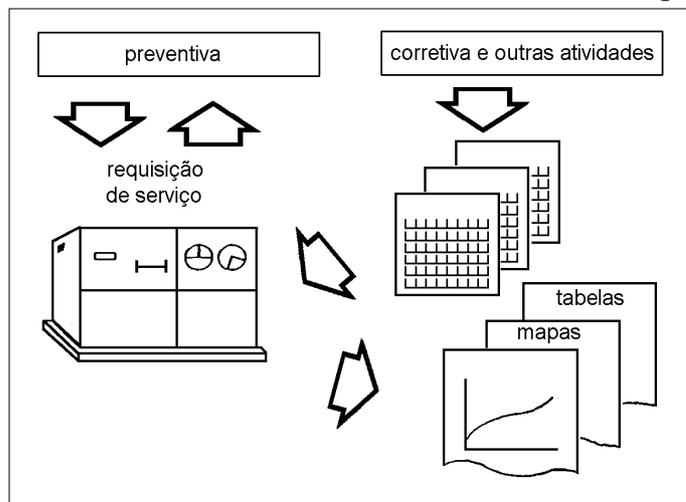
**Controle por microcomputador** – É o sistema no qual todos os dados sobre as intervenções da manutenção ficam armazenados no microcomputador. Esses dados são de rápido acesso através de monitor de vídeo ou impressora. Esquemáticamente:
