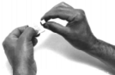
Em seguida, devem ser girados lentamente, exercendo-se uma pressão moderada até que suas faces fiquem alinhadas e haja perfeita aderência, de modo a expulsar a lâmina de ar que as separa. A aderência assim obtida parece ser consequência do fenômeno físico conhecido como **atração molecular** (com valor de aproximadamente  $500\text{N}/\text{cm}^2$ ), e que produz a aderência de dois corpos metálicos que tenham superfície de contato finamente polidas.
