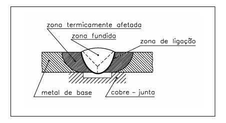
Na região próxima à junta soldada, está a **zona de ligação**, na qual se observa uma transição entre a estrutura do metal fundido e a do metal de base.
