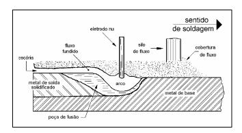
Uma vez aberto o arco, tanto o eletrodo quanto o fluxo são alimentados continuamente para a região do arco enquanto a tocha é deslocada. O eletrodo, parte da camada de fluxo e o metal de base fundem sob o calor do arco formando a poça de fusão.
