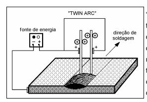
"Twin arc" (que quer dizer arcos gêmeos) trabalha com um ou mais eletrodos, usando uma ou mais fontes de energia soldando simultaneamente. Essa variante fornece menor penetração, baixa diluição e alta taxa de deposição. É empregado na execução de revestimentos e soldagem de chanfros largos com mata-junta.
