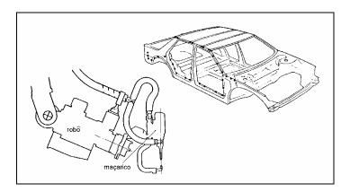
Com o auxílio de um painel de controle, chamado de "Teaching Box" ou "Caixa de Ensinamento", movimentamos manualmente o robô, fazendo com que o dispositivo de soldagem passe por todos os pontos desejados, um de cada vez. A cada ponto, pelo painel de controle, fazemos com que o computador de controle do robô memorize sua posição.
