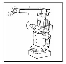
Os motores e os sensores estão ligados ao computador que controla o robô. Por meio do programa, o computador compara as ordens que você deu ao robô com a sua posição atual, conhecida por intermédio dos sensores. Se a posição em que o robô se encontra é diferente daquela que você desejava, o computador se encarrega de realizar as correções necessárias.
