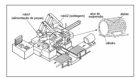
Para soldar os componentes (aletas, alças de suspensão, caixa de ligação etc.) no cilindro da carcaça, essa célula trabalha com dois robôs. O robô da esquerda (robô 1) tem a função de pegar o componente a ser soldado que se encontra sobre uma bancada, posicioná-lo sobre o cilindro da carcaça do motor e segurá-lo enquanto o robô da direita (robô 2) solda o componente.
