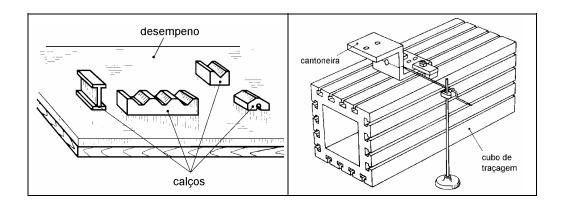
Para medir usam-se: escala, goniômetro ou calibrador traçador.
