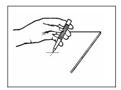
9. Em seguida, golpeia-se a cabeça do punção com o martelo. Como indicação prática, deve-se dar a primeira martelada com pouca força, verificar o resultado e dar um segundo golpe para completar a marcação.
