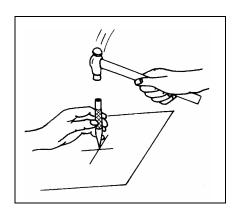
10. Para a traçagem de arcos de circunferência, usa-se o punção para marcar o centro da circunferência e o compasso para realizar a traçagem.
