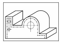
Como a traçagem consiste basicamente em desenhar no material a correta localização dos furos, rebaixos, canais, rasgos e outros detalhes, ela permite visualizar as formas finais da peça. Isso ajuda a prevenir falhas ou erros de interpretação de desenho na usinagem, o que resultaria na perda do trabalho e da peça.
