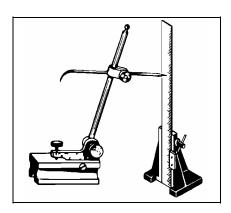
5. Traçagem, fazendo um traço fino, nítido, em um único sentido, ou seja, de uma vez só. Se os traços forem paralelos à superfície de referência, basta usar o graminho ou calibrador traçador.
