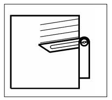
8. No caso de furos ou arcos de circunferência, marcar com punção e martelo. Esta operação é realizada colocando-se a ponta do punção exatamente na interseção de duas linhas anteriormente traçadas.
