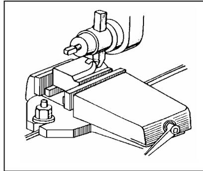
Para o aplainamento de superfícies internas de furos (rasgos de chavetas) em perfis variados, usa-se a plaina limadora vertical.
