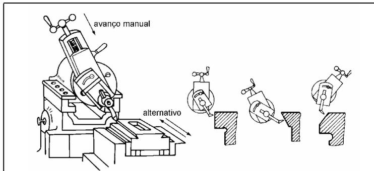
3. **Aplainar verticalmente superfície plana:** combina dois movimentos: um longitudinal (da ferramenta) e outro vertical (da ferramenta ou da peça). Produz superfícies de referência e superfícies perpendiculares de peças de grande comprimento como guias de mesas de máquinas.
