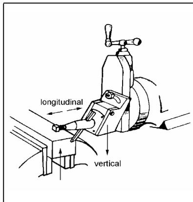
4. **Aplainar estrias:** produz sulcos, iguais e equidistantes sobre uma superfície plana, por meio da penetração de uma ferramenta de perfil adequado. As estrias podem ser paralelas ou cruzadas e estão presentes em mordentes de morsas de bancada ou grampos de fixação.
