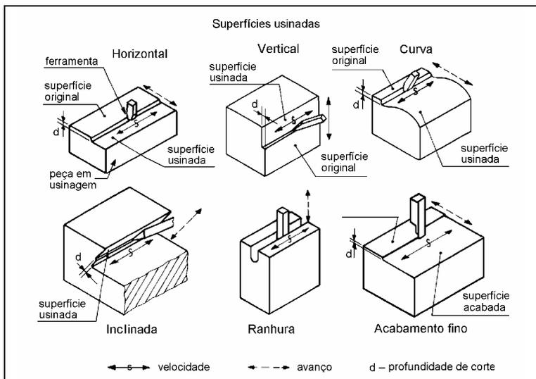
O aplainamento é uma operação de desbaste. Por isso, e dependendo do tipo de peça que está sendo fabricada, pode ser necessário o uso de outras máquinas para a realização posterior de operações de acabamento que dão maior exatidão às medidas.
