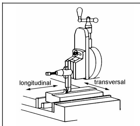
2. **Aplainar superfície plana em ângulo:** o ângulo é obtido pela ação de uma ferramenta submetida a dois movimentos: um alternativo ou vaivém (de corte) e outro de avanço manual no cabeçote porta-ferramenta.
