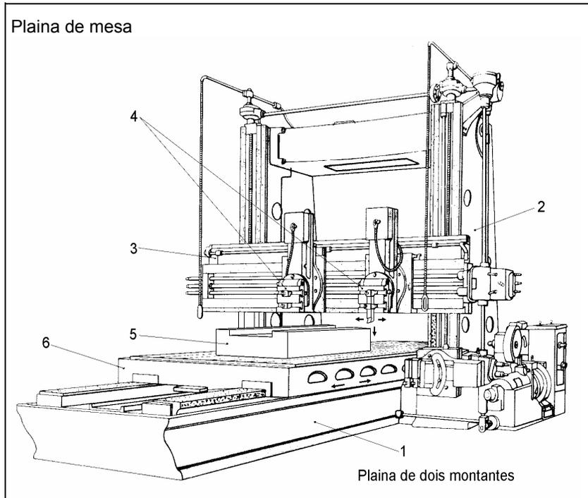
O curso da plaina de mesa é superior a 1.000mm. Usina qualquer superfície de peças como colunas e bases de máquinas, barramentos de tornos, blocos de motores diesel marítimos de grandes dimensões.
