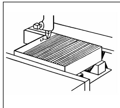
5. **Aplainar rasgos:** produz sulcos por meio de movimentos longitudinais (de corte) e verticais alternados (de avanço da ferramenta) de uma ferramenta especial chamada de **bedame**.
