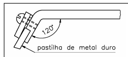
Como já vimos, a ferramenta para a raspagem chama-se raspador (ou rasquete). Os raspadores são fabricados em aço-carbono ou aço-liga extra duro e têm o formato semelhante ao de uma lima. Em sua extremidade prende-se uma pastilha de aço rápido ou de metal duro por meio de grampo ou por soldagem.
