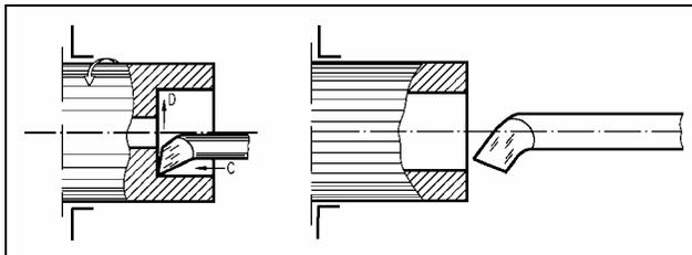
Depois de facear e fazer um furo com diâmetro suficiente para a entrada da ferramenta, as etapas da operação de broqueamento são as seguintes:
