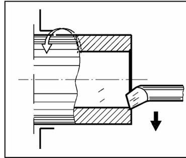
6. Torneamento de um rebaixo na boca do furo para servir como base para a medição.
