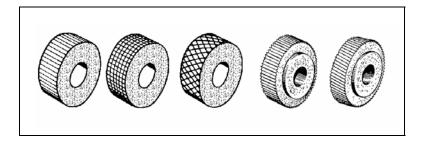
Para obter o recartilhado, monta-se a recartilha no portaferramenta da mesma maneira como uma ferramenta comum do torno. Os roletes são arrastados pela rotação da peça e, como estão firmemente pressionados contra ela, imprimem na sua superfície o desenho das estrias, à medida que o carro portaferramentas se desloca.
