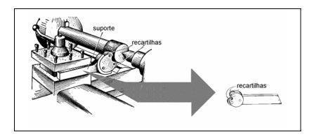
As recartilhas, que dão nome ao conjunto da ferramenta, são roletes de aço temperado, extremamente duros e que possuem uma série de dentes e estrias que penetram, mediante grande pressão, no material da peça. A superfície estriada resultante recebe o nome de **recartilhado**.
