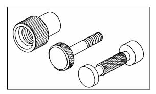
Pelo emprego de uma ferramenta chamada **recartilha**, obtém-se no torno a superfície com serrilhado desejado. Essa ferramenta executa na superfície da peça uma série de estrias ou sulcos paralelos ou cruzados.
