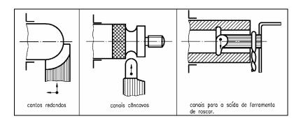
Tornear superfícies côncavas e convexas com uma ferramenta que se desloca simultaneamente com movimentos de avanço ou penetração, que o operador realiza com as duas mãos.
