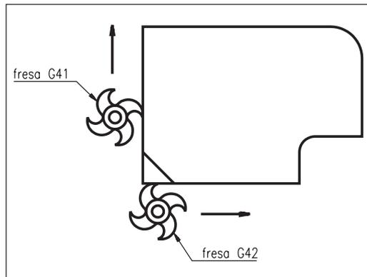
No nosso caso, escolhemos percorrer o perfil no sentido anti-horário. Assim, a fresa permanece à direita do perfil. Então, a função de compensação será G42.
