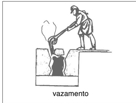
A temperatura alcançada, superior a  $1.300^{\circ}\text{C}$ , foi suficiente para obter uma massa líquida. A massa era vazada em recipientes com cavidades e assumia a forma desejada para o produto.
