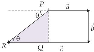
Para determinarmos o módulo do vetor  $\vec{R}$  e do ângulo  $\theta$ , aplicamos o teorema de Pitágoras, no triângulo PQR.
