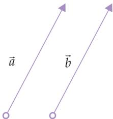
$$\vec{a} = \vec{b} \begin{cases} a = b & (\text{módulos iguais}) \\ \vec{a} \text{ e } \vec{b} & \text{são paralelos (mesma direção).} \\ \vec{a} \text{ e } \vec{b} & \text{possuem o mesmo sentido.} \end{cases}$$
