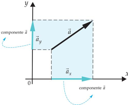
O vetor  $\vec{a}$  pode ser representado pelas suas componentes retangulares  $\vec{a}_x$  e  $\vec{a}_y$ , sendo válida a relação
