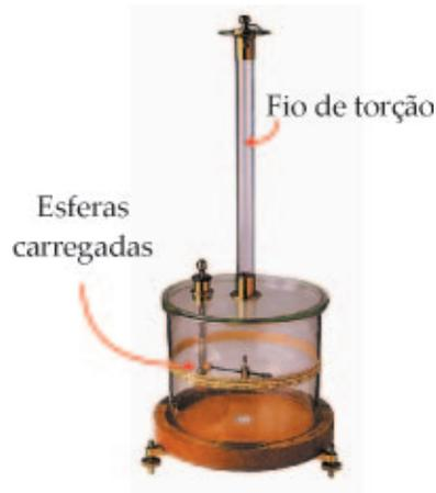
Balança de Coulomb. A medida da intensidade da força de atração ou repulsão entre as esferas carregadas A e B é feita pela torção do fio.
